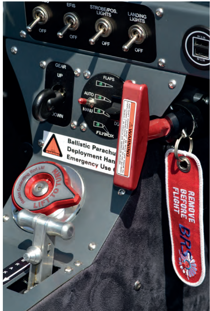
Elektrisch bediende kleppen, met autofunctie-switch.
