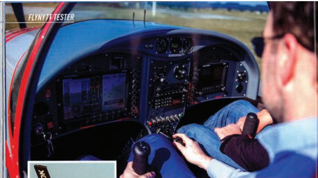
Glass og god plass: Breezer B600 E er utstyrt med moderne og oversiktlig Dynon-avlesnikk. Sheep turn: Litt kverter må til, men etter noen runder kjennes det helt naturlig.
